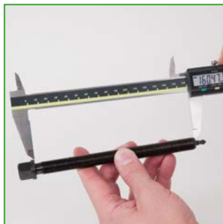
b Messen Sie die Gewindelänge bis zur Spindelspitze. Measure the thread length to the tip of the spindle.
