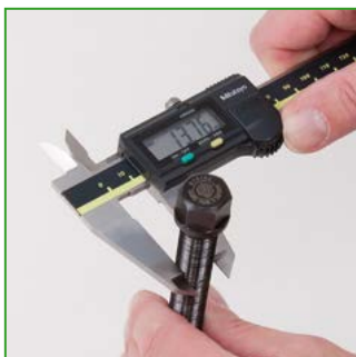
a Messen Sie den Spindeldurchmesser. Measure the spindle diameter.
